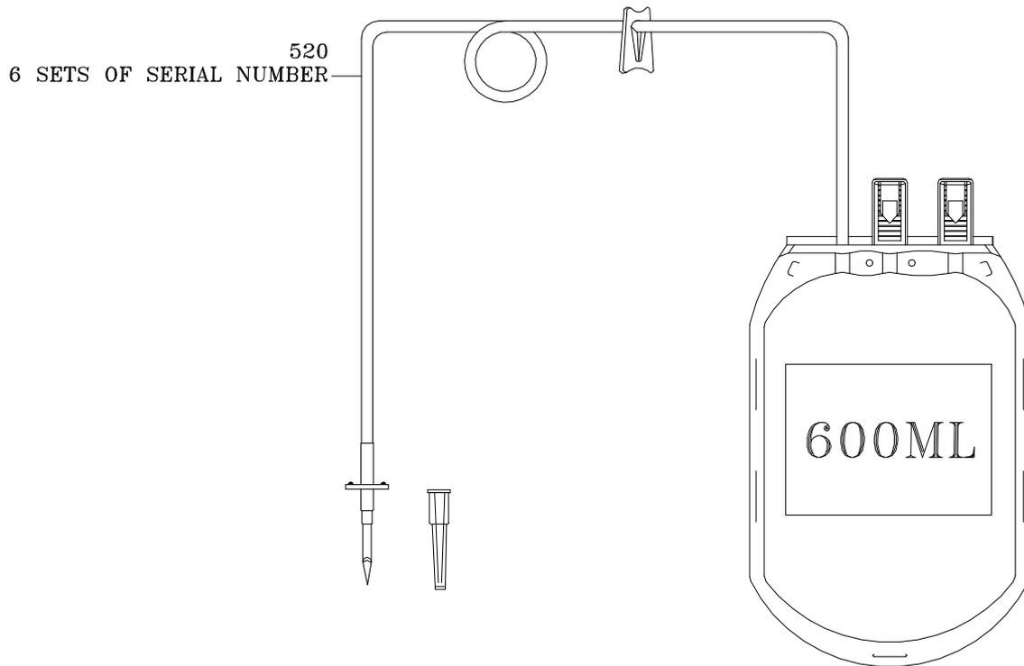
**B) Descrizione :** *Sacca Transfer da 600 ml con due porte di ingresso, un solo tubo con perforatore.*
